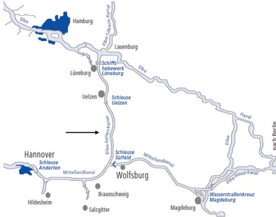
Der Elbe-Seitenkanal (ESK) zweigt bei der Ortschaft Edesbüttel aus der Scheitelhaltung des Mittellandkanals (MLK-km 233,6, ESK-km 0,0) ab, führt in Nordrichtung über das Allertal durch die Lüneburger Heide und mündet bei Artlenburg in den Staubereich der Elbe-Staustufe Geesthacht. Durch diesen leistungsfähigen Kanal sind die Seehäfen Hamburg und Lübeck an das Netz der Binnenwasserstraßen angeschlossen.
